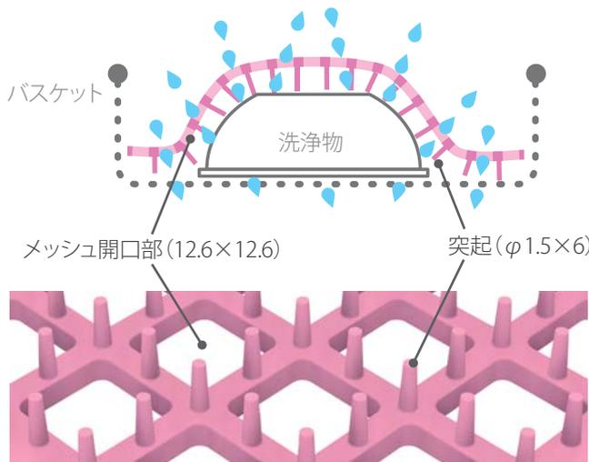
※ メッシュ本体の平面積に対し、突起先端部面積の合計との比率。
